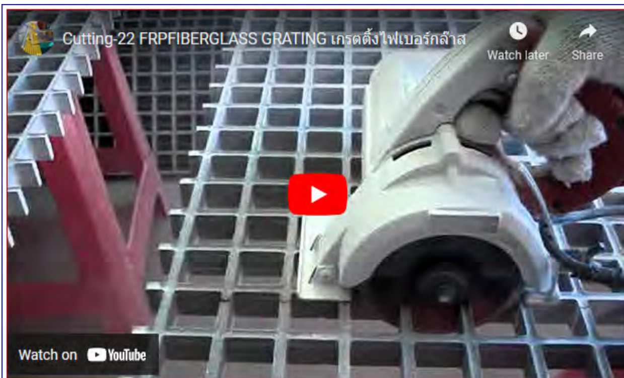
FRP Grating Cutting Method ตัดโดยเลื่อยวงเดือนใช้ใบตัดเพชร #2
